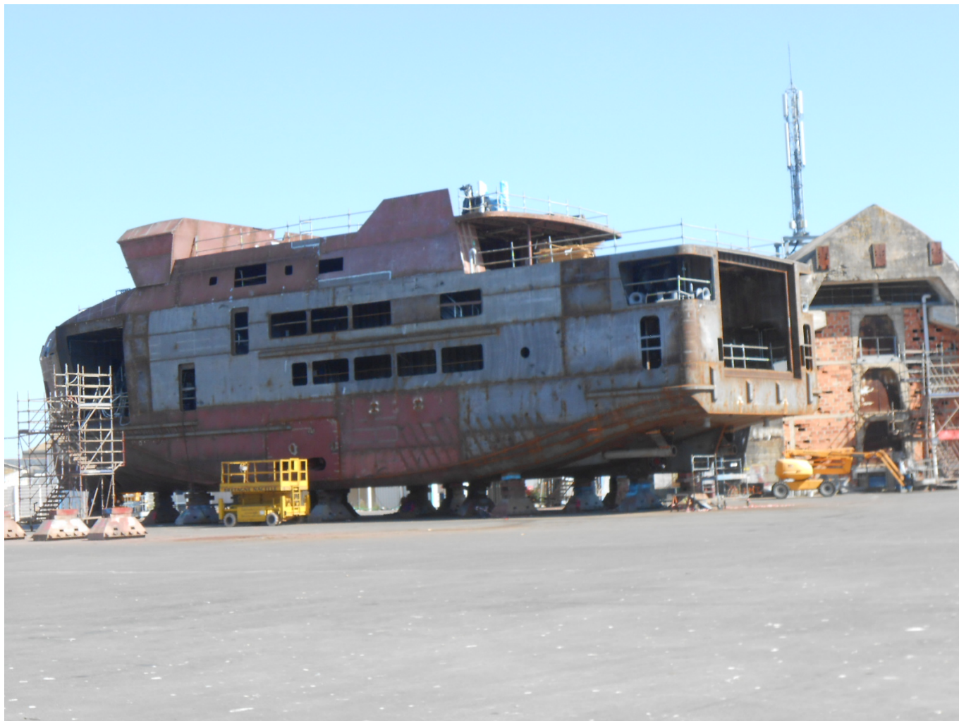
Le roulier en cours de fabrication au slipway
